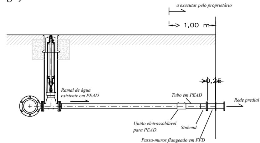
\* - Quando não seja necessário o passa-muros, dever-se-á utilizar uma união eletrossoldável, mantendo a tubagem para jusante em PEAD, numa extensão mínima de 1,00 metro
