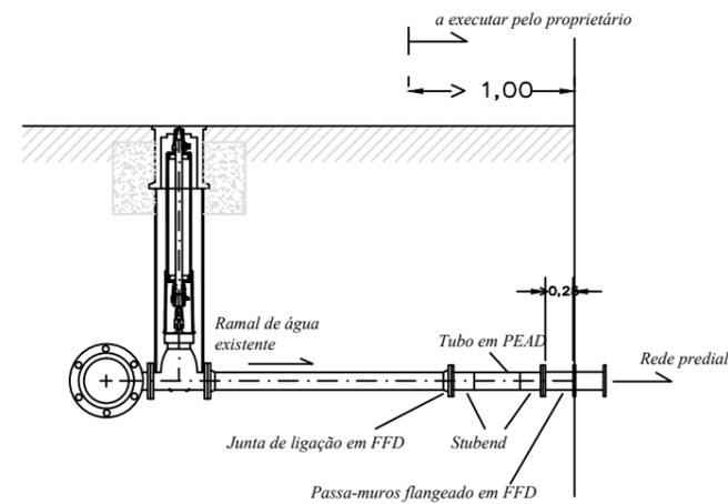
\* - Quando não seja necessário o passa-muros, dever-se-á utilizar uma união eletrossoldável, mantendo a tubagem para jusante em PEAD, numa extensão mínima de 1,00 metro
